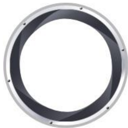
VELIK OTVOR BLENDE (ulazi mnogo svetlosti) f/2
