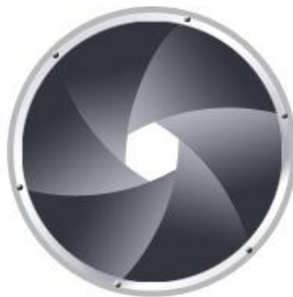
MALI OTVOR BLENDE (ulazi malo svetlosti) f/22
