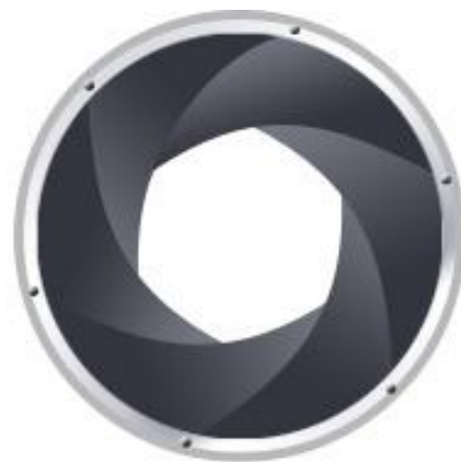
SREDNJI OTVOR BLENDE (srednja količina svetlosti) f/8
